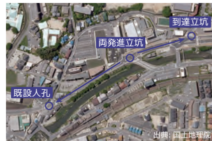
小口径推進工法の下水道設計 下水道有里幹線213号線
